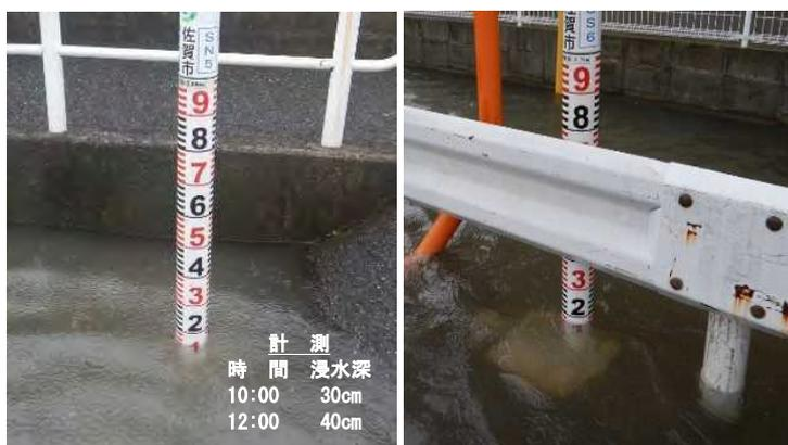
・ 観測点に付随する衛星点を複数箇所設けることで、面的な浸水状況を想定。
